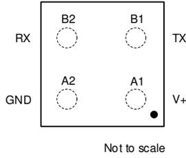
**Figure 5-1. YFF Package 4-Pin DSBGA (Top View)**
