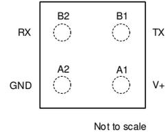
**Figure 5-2. YMT Package 4-Pin DSBGA (Top View)**
