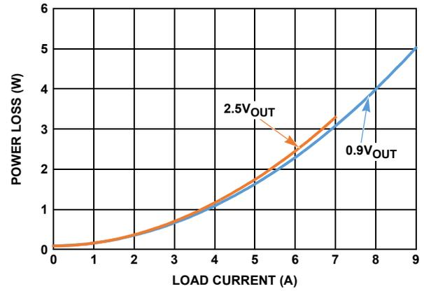
FIGURE 23. POWER LOSS,  $V_{IN} = 3.3V$ , 500kHz
