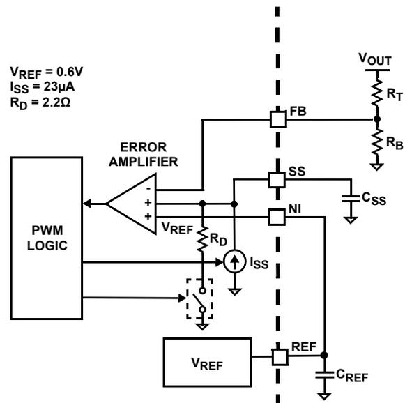
FIGURE 47. SOFT-START CIRCUIT
