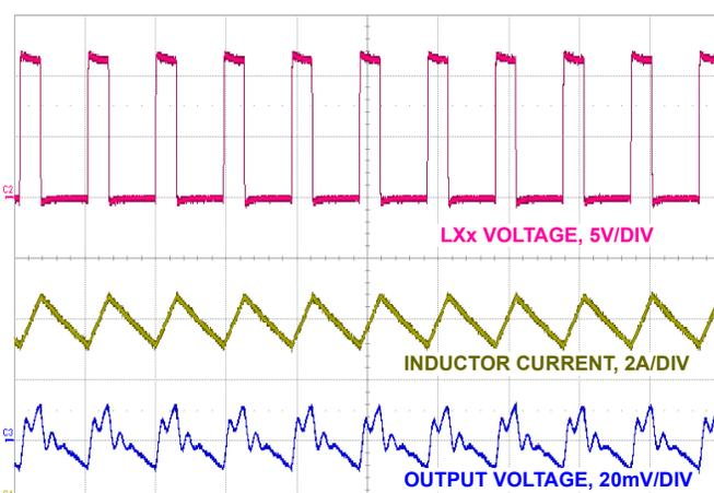
FIGURE 37. STEADY STATE OPERATION 6A LOAD, CCM
