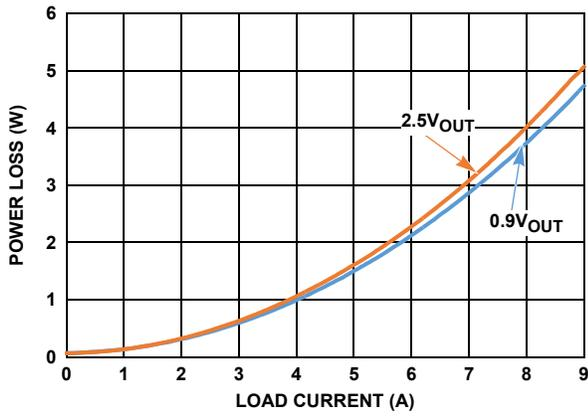
FIGURE 22. POWER LOSS,  $V_{IN} = 3.3V$ , 300kHz
