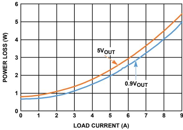
FIGURE 20. POWER LOSS,  $V_{IN} = 12V$ , 300kHz
