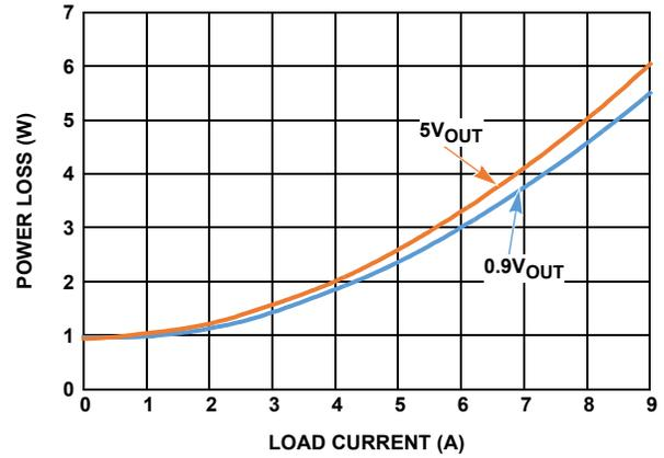
FIGURE 21. POWER LOSS,  $V_{IN} = 12V$ , 500kHz
